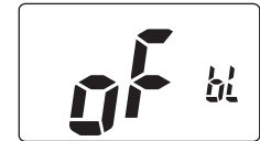
Automatische Beleuchtung OFF
