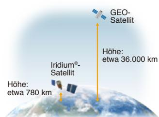
Satelliten-PTT-Funkgeräte nutzen Iridium®-Satelliten in niedrigen Erdumlaufbahnen (LEO) und gewährleisten eine Kommunikation mit Latenzzeiten, die im Vergleich zu Satelliten auf geostationären Umlaufbahnen (GEO), die sich in 50-fach größerer Höhe befinden, deutlich kürzer sind.
