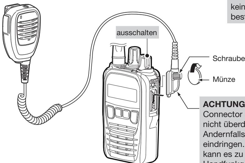
**HINWEIS:** Die Buchsenabdeckung **UNBEDINGT** geschlossen halten, wenn kein Lautsprechermikrofon an das Handfunkgerät angeschlossen ist. Obwohl auch bei abgenommener Buchsenabdeckung keine Feuchtigkeit in das Funkgerät eindringen kann, besteht die Gefahr, dass die Anschlüsse korrodieren.
