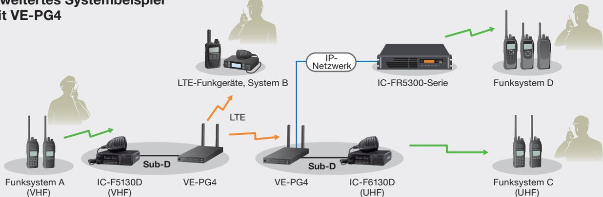
Das VE-PG4 ist ein vielseitiges RoIP (Radio over IP Network)-Gateway, das Funkgeräte der IC-F5130D-Serie mit anderen Funksystemen verbindet, auch wenn diese verschiedene Bänder nutzen\*.
