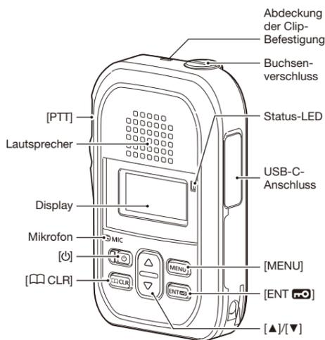
① Der USB-Anschluss unterstützt nicht die Stromversorgung per USB (USB Power Delivery, USB PD).
