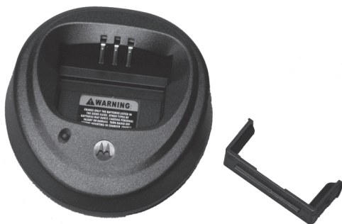
Figura 2 Guía de colocación de baterías retirada
