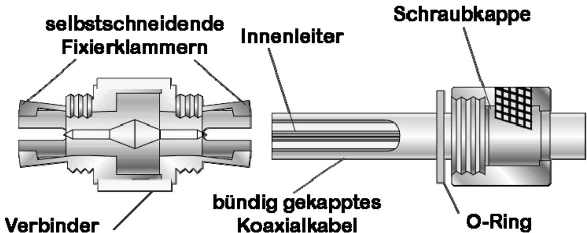
1. Schneiden Sie die Enden des Koaxialkabels sauber und bündig ab.
