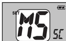
Prioritätssuchlauf: Durchsucht den Suchlaufspeicherkanal, Festkanal und Prioritätskanal (Kanal 16).
