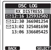
4. Drücken Sie den Softkey **[SELECT]** und drücken Sie dann die Taste **CH▼/CH▲**, um die Station (Name oder MMSI) zu wählen, die Sie überprüfen möchten, und/oder den Notruf an andere Fahrzeuge weiterzuleiten.
