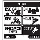
3. Drücken Sie die Taste **CH▼/CH▲**, um „WAYPOINT SETUP“ zu wählen, und drücken Sie dann den Softkey **[SELECT]**.
