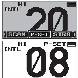
4. Um zum vorherigen Betriebskanal zurückzukehren, einen der Softkeys drücken, dann den Softkey [P-SET] drücken. Das Symbol „P-SET“ verschwindet vom Display.
