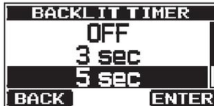
**3/5/10/20/30 Sec:** Beleuchtet das Display/Tastenfeld über die ausgewählte Zeit, wenn eine Taste gedrückt wird (außer der PTT-Schalter).
