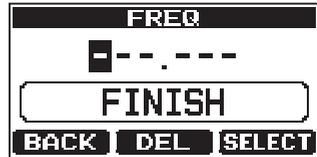
7. Schritt 5 und 6 wiederholen, bis die ganze Frequenz eingegeben ist.
