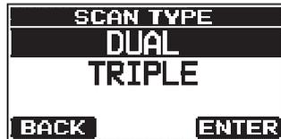
**DUAL** (Dual Watch): Das **HX210E** überwacht die Aktivität des aktuellen Kanals und des Prioritätskanals.
