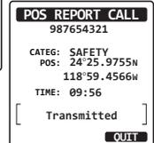
5. Wenn Sie die angezeigte Position ändern möchten, drücken Sie den Softkey **[POS/TM]**, um zum Bildschirm für die Eingabe der Positionsdaten zu wechseln. Drücken Sie nach der Eingabe der neuen Positionsdaten zur Bestätigung den Softkey **[FINISH]**.
