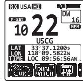
Das Funkgerät überwacht den Prioritätskanal und den Überwachungskanal, der in Schritt 2 gewählt wurde.
