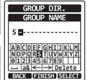
Wenn Sie beim Eingeben des Namens einen Fehler gemacht haben, drücken Sie die Taste **[CH▼]/[CH▲]/[◀]/[▶]**, um „←“ oder „→“ zu wählen, drücken Sie den Softkey **[SELECT]**, bis das falsche Zeichen markiert ist, und führen Sie dann die Schritte 3 und 4 durch.
