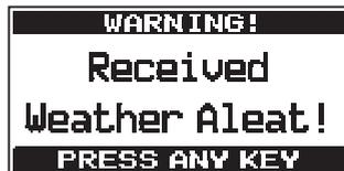
Nach Stoppen des Pieptons wird das Display zur Bestätigung des Empfangs von Wetterwarnungen angezeigt. Drücken Sie eine beliebige Taste, um das Bestätigungsdisplay anzuzeigen. Das Bestätigungsdisplay fragt, ob zum Wetterkanal gegangen oder zum Seefunkkanal zurückgekehrt werden soll. **[YES]** drücken, um zum Wetterkanal zu schalten oder **[NO]** drücken, um zum Seefunkkanal zurückzukehren.
