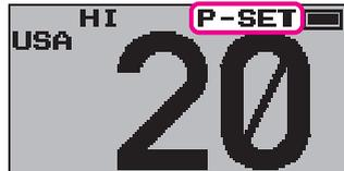
6. Schritte 1 bis 5 wiederholen, um die zusätzlichen Kanäle in die Festkanäle zu programmieren. Es können bis zu 10 Kanäle registriert werden. Wenn Sie versuchen, den 11. Kanal zu registrieren, ertönt ein Piepton zur Warnung vor dem Fehler.
