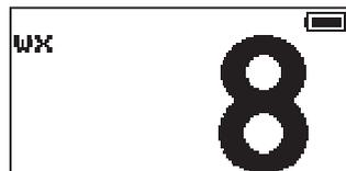
3. Um die NOAA-Wetterkanäle zu verlassen, die Taste **[MENU/SET]** drücken, um das MENU-Display anzuzeigen, dann den Softkey **[CH]** drücken. Das Funkgerät kehrt zu dem Kanal zurück, der vor dem Schalten in den Wetterkanalmodus in Gebrauch war.
