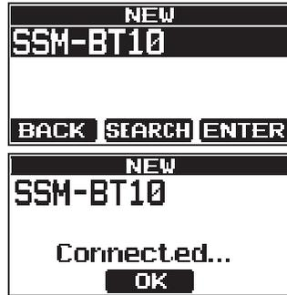
9. Den Softkey [OK] drücken, und dann die Taste [CLR/On] drücken, um zum Funkbetrieb zurückzukehren.
