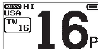
5. Wenn eine Übertragung auf dem Prioritätskanal empfangen wird, bleibt das **HX320E** auf dem Prioritätskanal, bis das eingehende Signal verschwindet.
