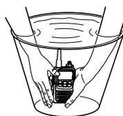
**SÄUBERN SIE DAS IP-HANDFUNKGERÄT SORGFÄLTIG MIT KLAREM WASSER**, wenn es mit Salzwasser in Berührung gekommen ist. Andernfalls können die Tasten, Schalter und Bedienelemente durch kristallisierendes Salz unbedienbar werden.
